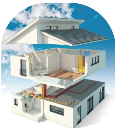
En associant la double flux KWL EC D avec le réseau de distribution d'air FlexPipe<sup>plus</sup>®, il devient simple, rapide et sûr de déployer et d'entretenir une installation double flux en logement individuel comme collectif.
